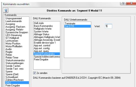
Anschließend den Inhalt des DTR als Stufenzeit setzen. Dazu das Kommando *Helligkeitwerte* → *Speichere Inhalt DTR Stufenzeit* verwenden. Ziel sind alle EVGs, auch hier den Haken bei *2x Senden* setzen und das Kommando mit **Kommando ausführen** absenden.
