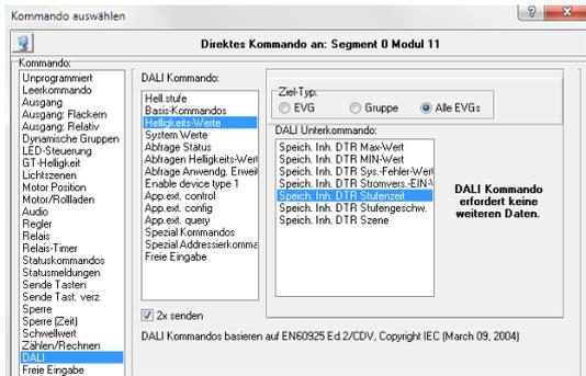
Mit dem Kommando *Spezial Kommandos* → *Set DTR* den Wert 9 in das DTR (Data Transfer Register) setzen. Dabei den Haken bei 2 x *Senden* setzen und das Kommando mit
