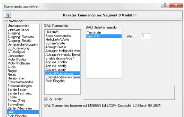
Anschließend den Inhalt des DTR als Stufgeschwindigkeit setzen. Dazu das Kommando *Helligkeitwerte* → *Speichere Inhalt DTR Stufengeschwindigkeit* verwenden. Ziel sind alle EVGs, auch hier den Haken bei 2x *Senden* setzen und das Kommando mit
